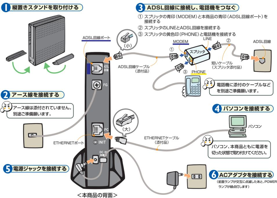
パソコンの電源を入れPOWERランプとLANランプとLINEランプが点灯していることを確認してください。
