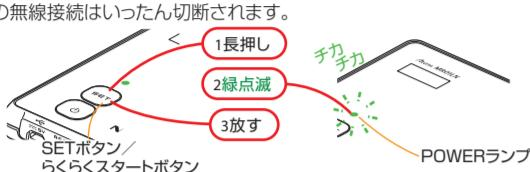
3 手順2から1分以内に、細い棒状のもの(電気を通さない材質のもの、つまようじの先など)でRESETスイッチを押し(約1秒)、放す(Powerランプが緑点灯する)
