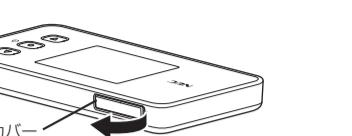
2 nanoSIM カードの IC 面（金属面）を上にして、nanoSIM カードスロットにまっすぐに差し込み、カチッときがするまで指先などで押し込む
