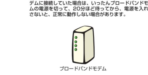
※プロードバンドモードをパソコンや他のプロードバンドモードに接続していた場合は、いったんプロードバンドモードの電源を切って、20分ほど待ってから、電源を入れ直さないと、正常に動作しない場合があります。
