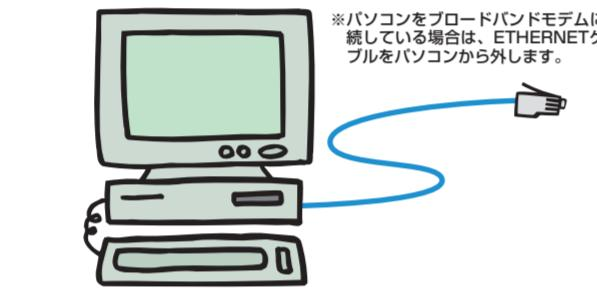
※パソコンをプロードバンドモードに接続している場合は、ETHERNETケーブルをパソコンから外します。
